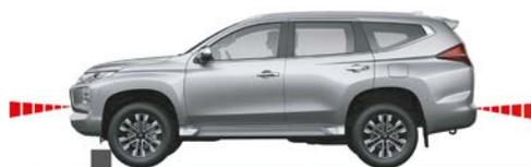
**SISTEMA ULTRASÓNICO DE MITIGACIÓN DE ACCELERACIÓN POR ERROR (UMS)**
