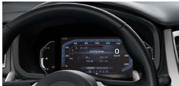
**TABlero DE INSTRUMENTOS DIGITAL DE 8" LCD
